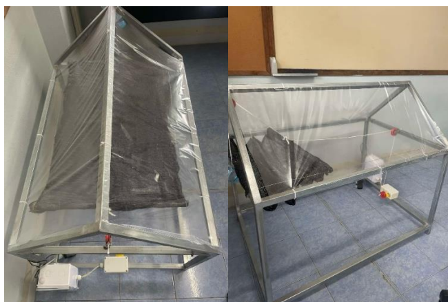
ภาพที่ 4 แสดงภาพมูบมและมูมข้างของต้นแบบระบบม่านพรางแสง บนโมเดลจำลองโรงเรือนเพาะปลูก
